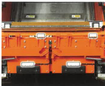
■ Příklad montáže RFID antén na svozovém vozidle
